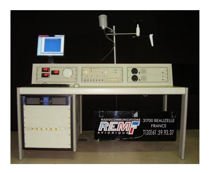
Alimentation 230V-24V triplée avec batteries de secours internes autonomie 2 à 6 heures Enregistreur numérique-dépouillement et contrôle par PC et logiciel Equipement météo Pulsonic Platine de contrôle balisage et synoptique interfacé ADB Double platine émetteurs-récepteurs
